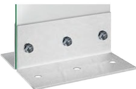
Die Winkel für die unterflurmontierten Außenstelen werden aus 16mm starken (bis 2.000 mm Glashöhe) bzw. 20mm starken (Glashöhe > 2.000 mm) feuerverzinkten Stahl gefertigt. Die Winkel besitzen jeweils am vertikalen und horizontalen Schenkel je nach Breite 3 oder mehr Lochbohrungen (Ø 20mm/14mm). Die Verbindung erfolgt mit Gewindestangen und Hutmuttern aus Edelstahl.
