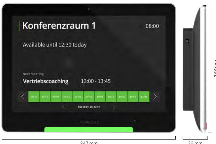
Stromversorgung erfolgt über Power over Ethernet (POE) oder 12V Spannungsversorgung (nicht inbegriffen)
