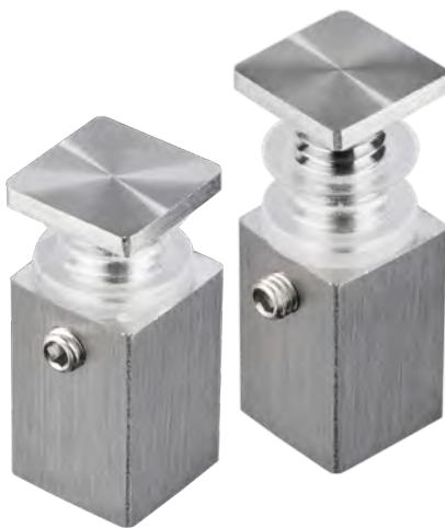
Die quadratischen Schildhalter der ConFix4-Serie sind attraktiv und außergewöhnlich. Der Aufbau des zweiteiligen Halters ist durchdacht, so dass die Montage unproblematisch ist: Der Schaft des Halters wird mit einer Schraube an der Wand befestigt, der Schraubbolzen wird durch das Schildmaterial gesteckt und dann in den Schaft eingedreht. Zur Sicherung bietet dieser Halter sowohl ein Linksgewinde als auch eine seitliche Madenschraube.
