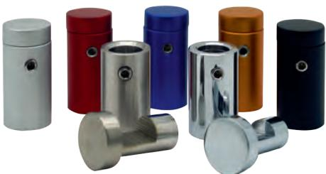
Für Schildmaterial ohne Lochbohrungen bietet die EcoLine-Serie zwei Varianten mit Klemmbefestigung, mit 15 und mit 25 mm Durchmesser (jeweils 25 mm Wandabstand). Der zweiteilige Aufbau ermöglicht das Befestigen von Materialstärken von 1-10 mm. Neben der Edelstahl-Ausführung gibt es Varianten aus Aluminium, die in den Farben silber, schwarz, rot, blau oder gold eloxiert bzw. hochglänzend im Chrom-Look beschichtet sind.
