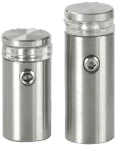
Die zeitlosen und eleganten Schildhalter der ConFix5-Serie wurden entwickelt, um auch sehr dünnes Schildmaterial (je nach Ausführung ab 1 mm) einzuspannen. Zudem gibt es diese Halter für verschiedene Lochbohrungen des einzuspannenden Materials von 5 und 10 mm. Der zweiteilige Aufbau bestehend aus seitlich geriffeltem Bolzen mit Kopf und Schaft, unterstützt eine einfache Montage:
